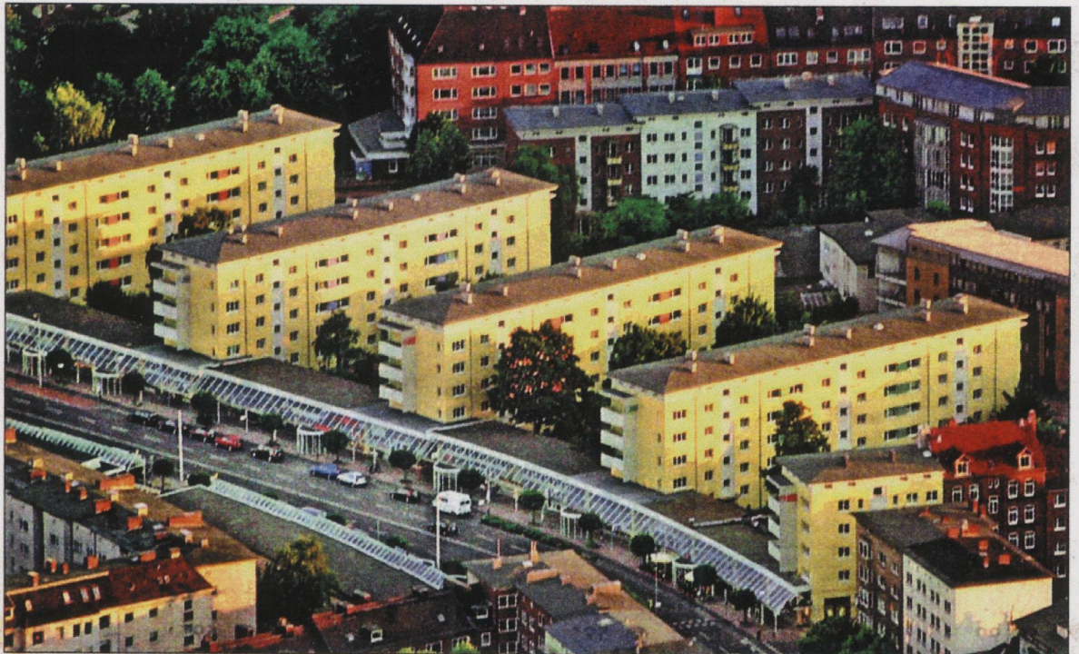
Die Kersig-Häuser an der Holtener Straße hinter den Arkaden sehen nicht nur schöner aus, sie sind auch wesentlich besser isoliert. So gut, dass das Sanierungsprojekt einen von zwei ersten Preisen beim Stadtwerke Umweltpreis einheimste. Fotos JKK
